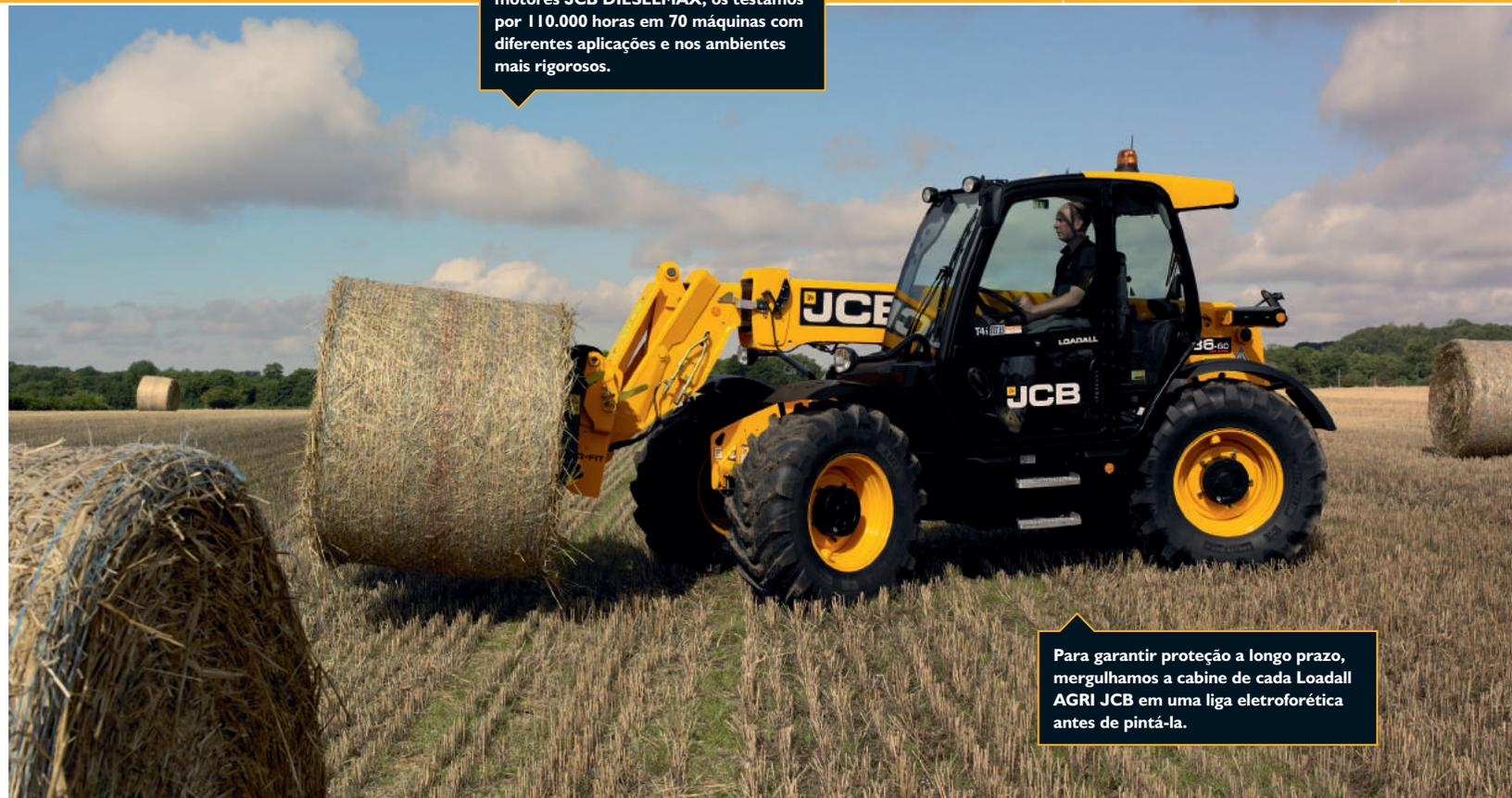
Para garantir proteção a longo prazo, mergulhamos a cabine de cada Loadall AGRI JCB em uma liga eletroforética antes de pintá-la.
