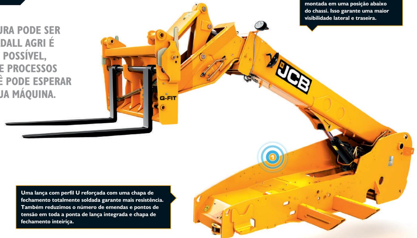
Uma lança com perfil U reforçada com uma chapa de fechamento totalmente soldada garante mais resistência. Também reduzimos o número de emendas e pontos de tensão em toda a ponta de lança integrada e chapa de fechamento inteira.
